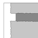
Etwa 10 mm tiefe Fugen rufen auf der Mauer ein besonders intensives Spiel von Licht und Schatten hervor. Sie werden mit einem geraden Fugeisen erzeugt.
