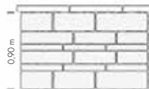
Zu einer Versandeinheit gehören jeweils 3 verschiedene Steinlängen. Die Lieferung von einzelnen Steinlängen ist nicht möglich. Eine Erweiterung der regelmäßigen und unregelmäßigen Schichtmauer ist mit den Steinen der Steinhöhe 7,5/15,0/22,5 cm realisierbar.
