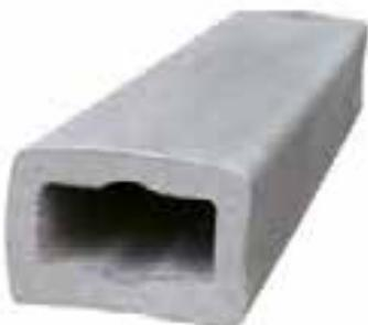
Die Rechteckpalisaden weisen leicht gewölbte Seitenflächen auf. Beim Aneinanderreihen der Palisaden legen sich die gewölbten Seiten ineinander, ein gewisser Formschluss entsteht, das erhöht die Stabilität. Zudem lassen sich die Palisaden sowohl längs als auch quer einsetzen.
