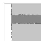
Bündige Fugen betonen die Linienführung der Mauer. Sie werden mit dem geraden Fugeisen abgezogen – sehr breite Fugen mit dem Pinsel glatt gestrichen.
